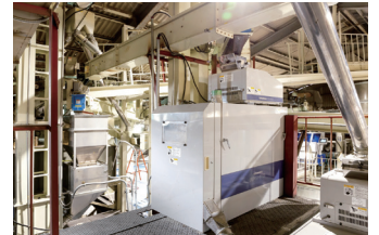
11 シフター 微振動を網目に伝えてふるいにかけて、米の大きさを選別します。
