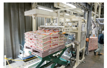
● メカパレ 自動でパレットに積み上げる機械です。
