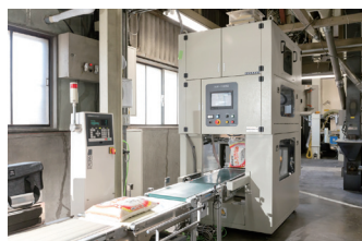
12 自動小袋計量包装機 計量器を2基搭載し、高速で精米を自動的に計量包装する機械です。
