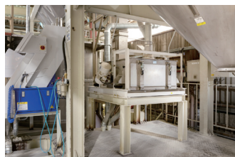
07 パイブロスクリーン 微振動を網目に伝えてふるいにかけ、米の大きさを選別します。
