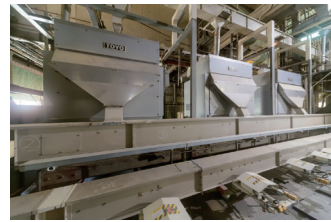
03 玄米石抜き機 石、ゴミなどを取り除きます。
