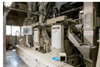
04 高性能精米本機 お米の負荷が少ない低温精米で品質の安定をはかる最新鋭の精米機です。
