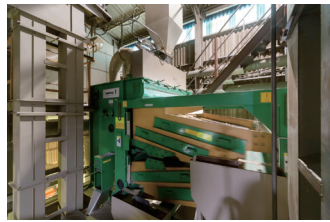
02 粗選機 これから精米される玄米に含まれる砕米、ゴミ、木片、髪の毛、その他異物を除去します。
