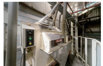
05 白米石抜き機 石を取り除くだけでなく、残留米排出装置も備えています。
