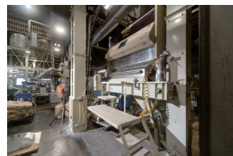
08 ハイパーソーター CCDカメラであらゆる異物を識別し瞬時にエアガンで取り除く最新鋭の選別機です。
