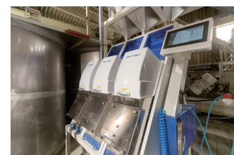
● スラッシュ 2種類のカメラでチェックし、着色粒、ガラス、石等の異物を検出し、エア噴射により選別除去します。
