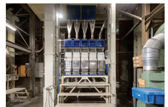
09 ピカ選GRAND 高性能フルカラーCCDカメラ・近赤外カメラにより、高精度な選別除去を行います。
