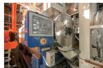
● NTWP (無洗米加工装置) 白米にごくわずかの水分を加えた後、体に安全なタビオカ澱粉によりヌカ層をきれいに取り除きます。
