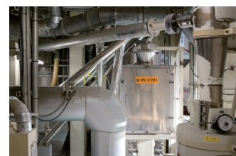
● ロータリーシフター 網目の違う3種の選別網を使用し大きさを基準に糠玉・整粒・小砕粒・糠に選別します。
