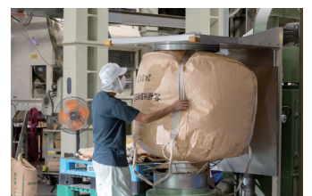
● フレコンクリーナー 水を使わず、強力な気流でフレコン内部を清掃し2つのフィルターで異物や塵を除去します。
