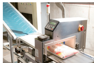
14 金属探知機 バックされた製品の金属チェックを行います。
